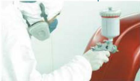
Для окраски пластиковых деталей используется тот же алгоритм, что и при работе с металлическими. Однако, в случае с пластиком, для предотвращения образования сколов и трещин в акриловые грунты, лаки и эмали рекомендуется добавлять Пластификатор RX N-11. Перед окраской поверхность пластиковой детали необходимо обработать матирующим полотном серого цвета, обезжирить, нанести адгезионный грунт по пластмассе RX P-05 в один слой (5-10 мкм). Для нанесения грунта используют
