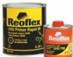
Двухкомпонентный быстрый акриловый грунт UHS с высоким сухим остатком отличается быстротой сушки 90 минут при 20°C, что позволяет уменьшить длительность рабочего процесса и снизить затраты на ремонт. Быстрый грунт UHS можно использовать методом «мокрый по мокрому», а также наносить прямо на металл и на пластик.
